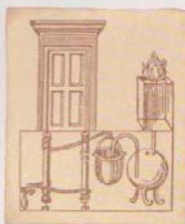
Использование блока в скрытом механизме открывания дверей в древнем храме
